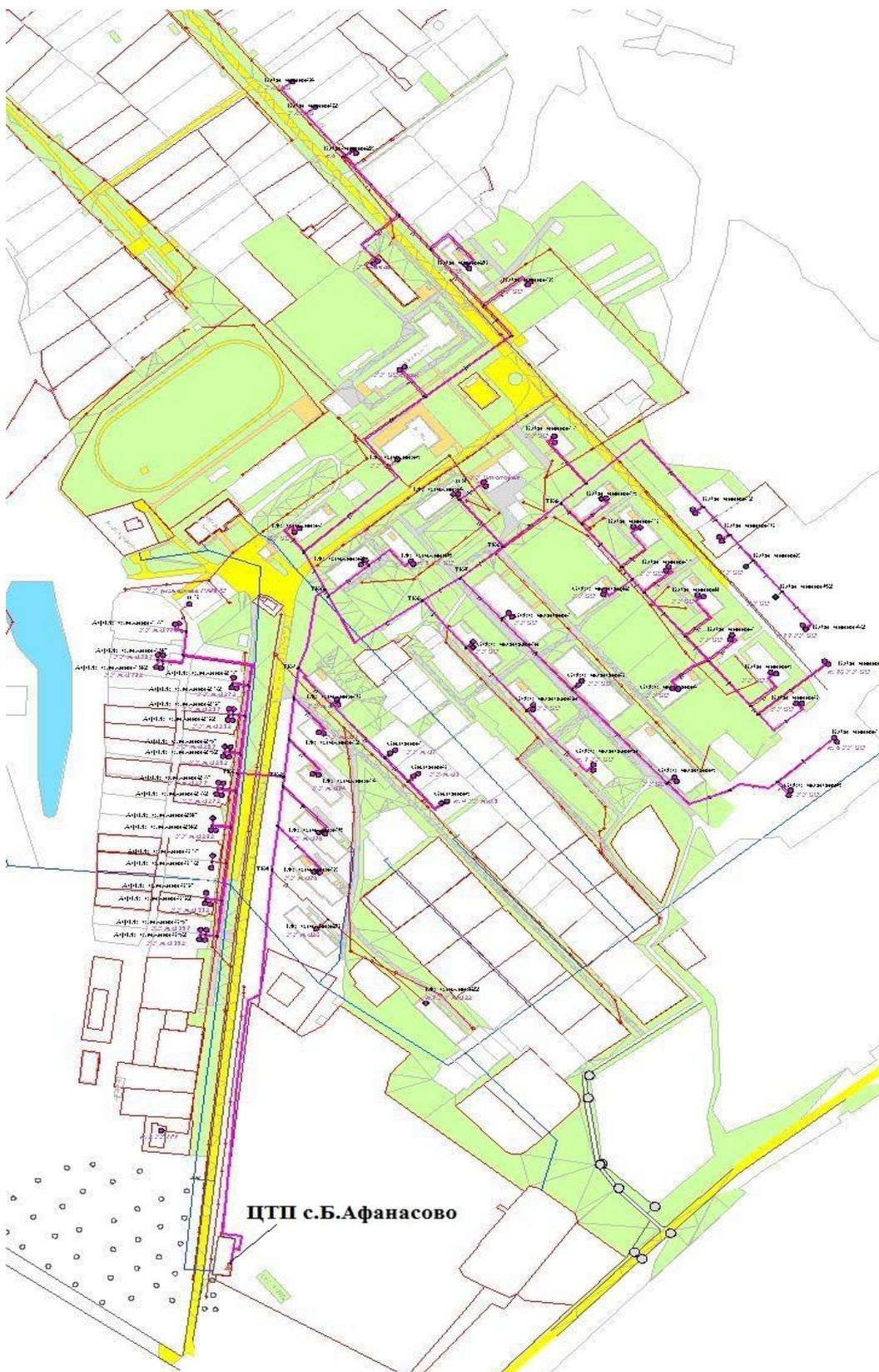
Рисунок 3-1. Схема тепловых сетей н.п. Большое Афанасово
